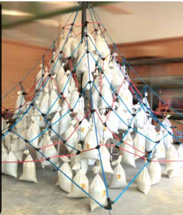
Belastungstest der Kletterpyramide mit 3 to
